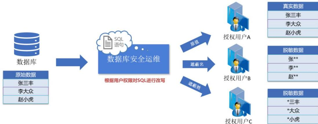
DS-DSOM 支持的脱敏规则主要有遮蔽、按位遮蔽、随机字符串、禁止访问、固定值和字符串截取/截断等。
