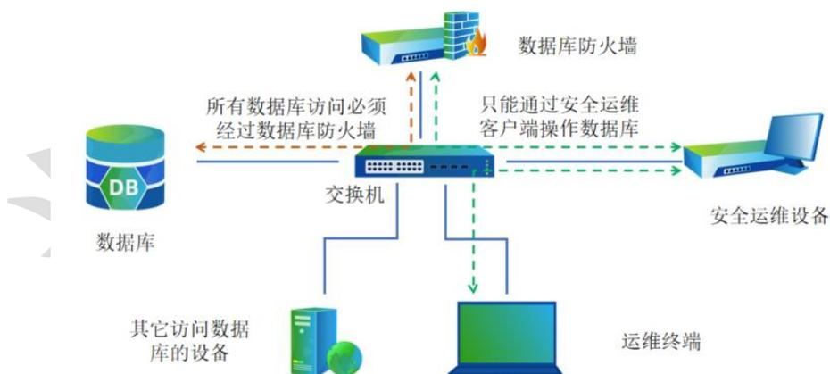
数据库设置为只接收防火墙的访问，数据库防火墙成为数据库的唯一入口。通过防火墙设置，所有的运维操作必行经过安全运维系统，通过防火墙提供额外的攻击保护功能。
