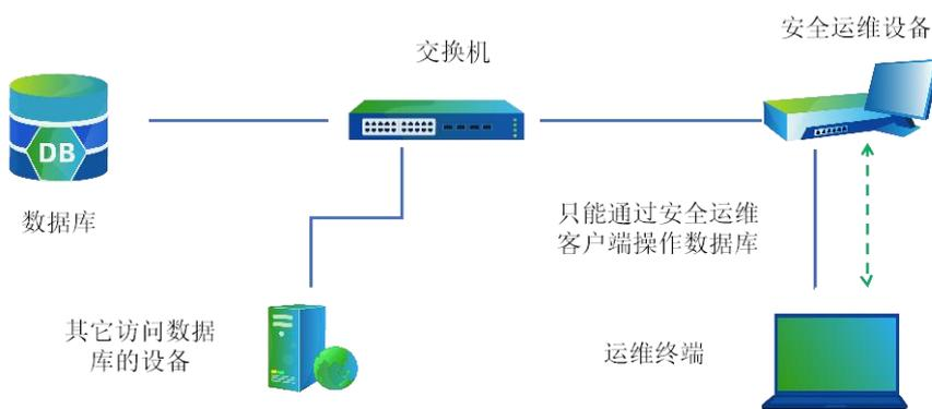
也可以采用逻辑串联的方式接入。安全运维系统单臂接入网络，以代理的方式接收所有的运维流量，分析和处理后转发到数据库。
