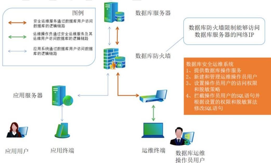
DS-DSOM 以逻辑串联的方式部署于运维终端和数据库服务器中间，所有的运维操作都必须经过 DS-DSOM 过滤或改写后才发送给数据库。
